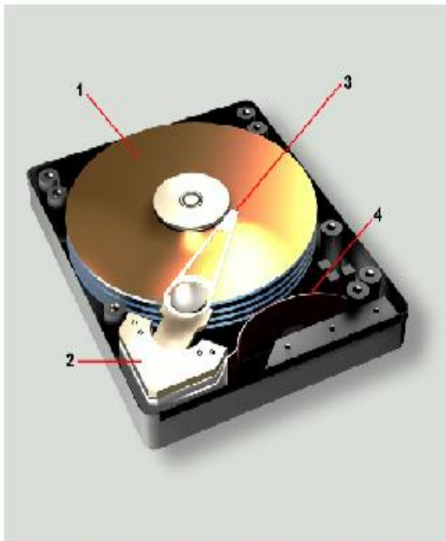
Budowa dysku twardego: 1 - dyski magnetyczne, 2 - głowice zapisująco-odczytujące, 3 - silnik napędu głowic, 4 - przewody łączące głowice z układami sterowania
